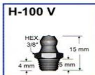
Han sido diseñados para barrenos no roscados, con el objeto de eliminar el costo de roscado. Su instalación a presión permite que entre la grasea y el barreno no queden pequeños espacios, porque el material del barreno se adapta a la forma de la rosca, evitando de esta manera fugas, ya que queda permanentemente sellada. Este tipo de graseas no pueden utilizarse en barrenos templados.
