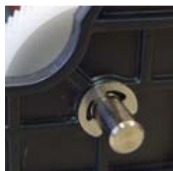
Anillo N1500 Retiene un eje de un cartucho de tónor.
