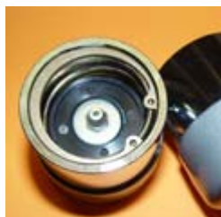
Anillo N1300 Protector de rodamiento de la rueda.
