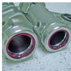
Anillo N1300 En caja de cremallera de dirección
