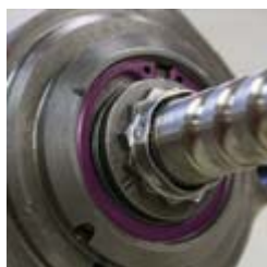
Anillo N1300 En caja de cremallera de dirección
