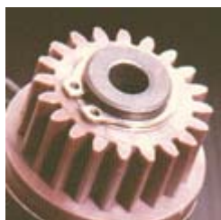
Anillo N1500 Retiene un eje de un cartucho de tónor.
