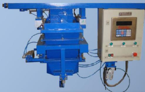
**SISTEMA DE PESAJE:** 100% electrónico con celdas de carga de acero.
