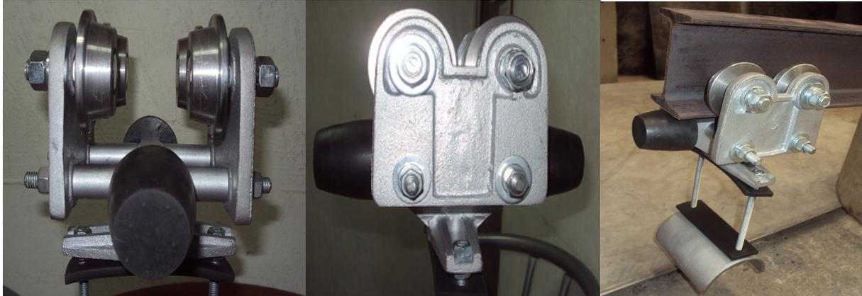
LA CARRETILLA ESTA DISEÑADA PARA EL SOPORTE Y TRASLADO DE CABLE PLANO, CON AJUSTE HORIZONTAL QUE NOS PERMITE CERRAR O ABRIR Y TENER EL CONTACTO ADECUADO EN LA PISTA DE RODAMIENTO, TAMBIEN CUENTA CON NEOPRENO DE ALTO IMPACTO AL FRENTE Y ATRÁS, EVITANDO EL GOLPE SEVERO ENTRE CABLES, POR ULTIMO LAS PLACAS LATERALES ESTAN FABRICADAS EN ALUMINIO, SIENDO UN CARRO LIGERO EN SU TIPO.
